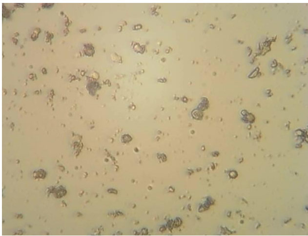
Фото.4 Порошок цеолита под микроскопом. Цена деления шкалы 100мкм.
