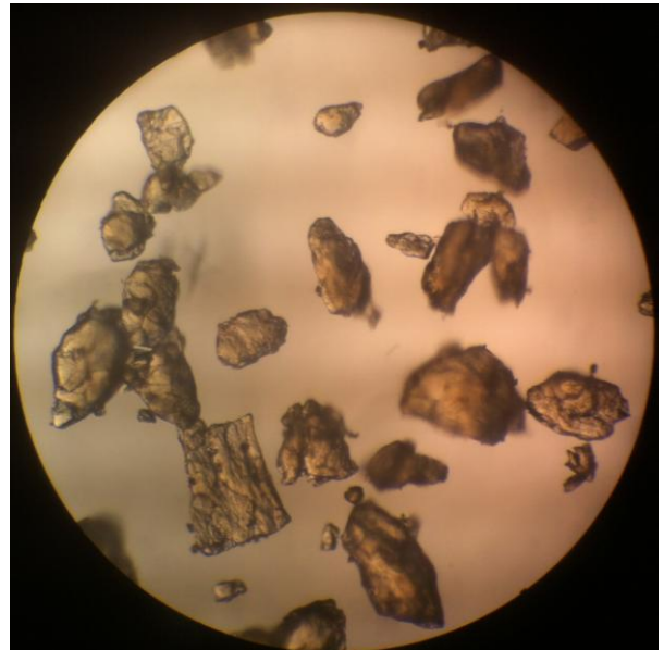
Рис.5 Порошок из фторопласта - отсев 125-250 мкм в поле микроскопа. Увеличение 160х. Размер наблюдаемого поля 1250мкм.
